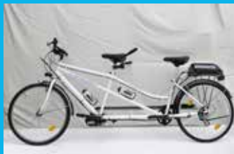
Esempio di trasformazione di bicicletta tradizionale e tandem in bicicletta a pedalata assistita (e-bike | e-tandem)
