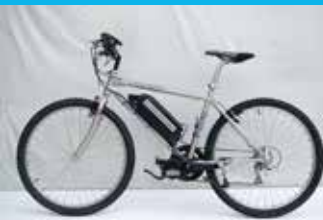
Esempio di trasformazione di bicicletta tradizionale e tandem in bicicletta a pedalata assistita (e-bike | e-tandem)
