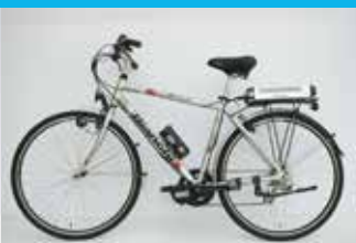
Trasformazione di bicicletta tradizionale in bicicletta a pedalata assistita con batteria in sacchetto o su portapacchi posteriore.
