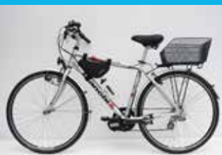
Trasformazione di bicicletta tradizionale in bicicletta a pedalata assistita con batteria in sacchetto o su portapacchi posteriore.
